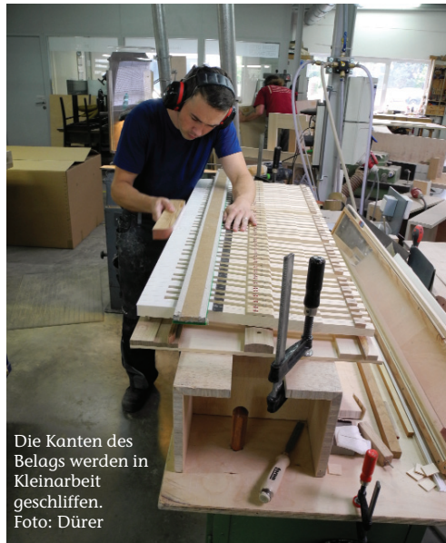
Jede einzelne Taste wird nach dem Schneiden noch ausgerichtet. Foto: Dürer
