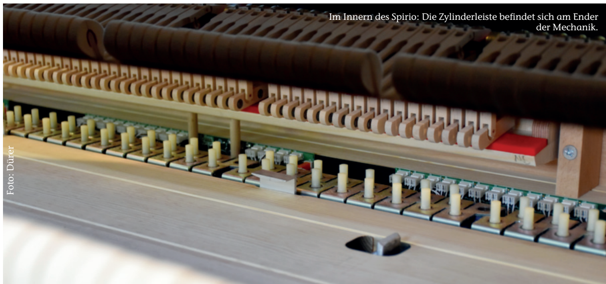
So sehen die die Tasten bewegenden Zylinder aus, dahinter erkennt man die elektronischen Steuerlemente.
