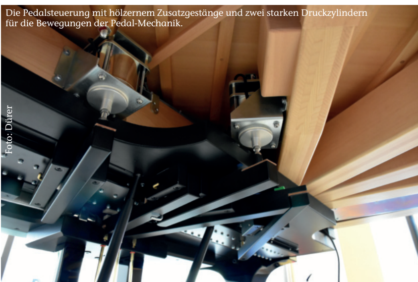
Die vielen kleinen Schrauben, die für die Zylinder zuständig sind, zeigen, dass man diese auch justieren kann.
